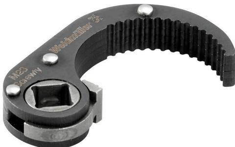
Der Screwty® Aufsatz ist sowohl für freikonfektionierbare M23 Rundsteckverbinder, als auch für umspritzte M23 Rundsteckverbinder, mit einem Außenmaß der Rändelmutter von  $26,2 \pm 0,3$  mm, geeignet. Das Anzugsdrehmoment liegt bei 2-2,5 Nm.
