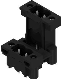
Hochtemperaturfeste, doppelstöckige, seitlich versetzte, geschlossene Stiftleiste optional mit Lötfansch. Lötstift 1,5 mm für Reflowlötanwendungen geeignet. Lötstift 3,2 mm für Reflow- und Wellenlötanwendungen geeignet. Die Stiftleisten bieten Platz für Beschriftungen und können kodiert werden.
