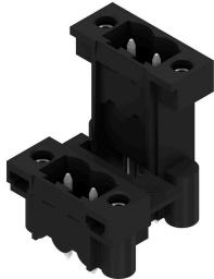
Hochtemperaturfeste, doppelstöckige, seitlich versetzte, geschlossene Stifteleiste optional mit Lötflansch. Lötstift 1,5 mm für Reflowlötanwendungen geeignet. Lötstift 3,2 mm für Reflow- und Wellenlötanwendungen geeignet. Die Stifteleisten bieten Platz für Beschriftungen und können kodiert werden.
