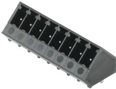
Die hochtemperaturfeste Stiftleiste SC-SMT in 135°-Abgangsrichtung - der Winkel von 135° wird definiert zwischen Steckrichtung und Lötpin und kennzeichnet eine schräge Abgangsrichtung mit 45° zur Leiterplatte.
