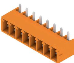
Die Stifteleiste SC in 270°-Abgangsrichtung - der Winkel von 270° wird definiert zwischen Steckrichtung und Lötpin und kennzeichnet die Steckrichtung parallel zur Leiterplatte, jedoch für das Stecken von Buchsenleisten über Kopf.
