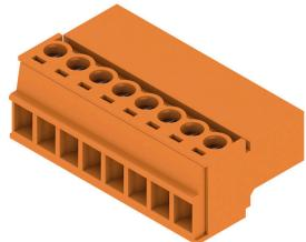
Der invertierte Stiftstecker SCZ mit Schraubanschluss in Zugbügeltechnik für Leiteranschluss mit gerader Abgangsrichtung im Raster 3,81 mm ist doppelt einsetzbar:
