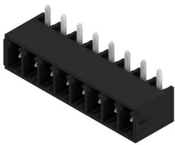
Die hochtemperaturfeste Stiftleiste SC-SMT in 270°-Abgangsrichtung - der Winkel von 270° wird definiert zwischen Steckrichtung und Lötpin und kennzeichnet die Steckrichtung parallel zur Leiterplatte, jedoch für das Stecken von Buchsenleisten über Kopf.
