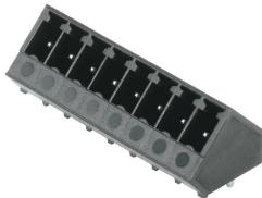
Die hochtemperaturfeste Stiftleiste SC-SMT in 135°-Abgangsrichtung - der Winkel von 135° wird definiert zwischen Steckrichtung und Lötpin und kennzeichnet eine schräge Abgangsrichtung mit 45° zur Leiterplatte.
