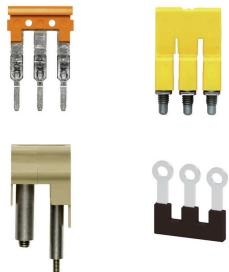
Die Verteilung oder Vervielfältigung eines Potentials auf benachbarte Reihenklemmen wird über eine Querverbindung realisiert. Zusätzlicher Verdrahtungsaufwand lässt sich so einfach vermeiden. Auch bei ausgebrochenen Polen ist weiterhin eine Kontaktsicherheit in den Reihenklemmen gewährleistet. Unser Portfolio bietet steck- und schraubbare Querverbindungssysteme für Reihenklemmen an.
