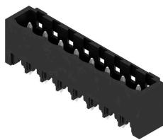
Hochtemperaturfeste Stifteleiste mit Verpackung in Box oder Tape. Im Tape mit 1,5 mm Lötstift optimiert für die Automatenbestückung. Lötstift 3,2 mm für Reflow- und Wellenlötanwendungen geeignet. Die Stifteleisten sind beschriftbar und können kodiert werden. HC = High Current.
