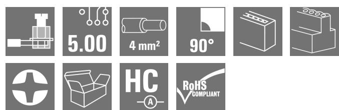
Buchsenstecker mit Schraubanschluss in Zugbügeltechnik für Leiteranschluss mit rechtwinkliger (90° bzw. 270°) Abgangsrichtung. Die Buchsenstecker bieten Platz für Beschriftungen und können kodiert werden. Befestigung mittels Flansch oder Löseriegel möglich. Sie bieten zusätzlich integrierte Plus/Minus-Schraube, Leiteruntersteckschutz und werden mit geöffnetem Zugbügel geliefert. HC = High Current.
