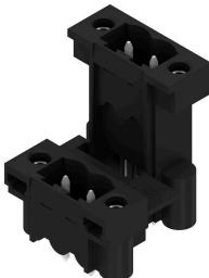
Hochtemperaturfeste, doppelstöckige, seitlich versetzte, geschlossene Stifteleiste optional mit Lötfansch. Lötstift 1,5 mm für Reflowlötanwendungen geeignet. Lötstift 3,2 mm für Reflow- und Wellenlötanwendungen geeignet. Die Stifteleisten bieten Platz für Beschriftungen und können kodiert werden.
