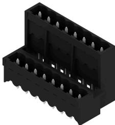
Hochtemperaturfeste, doppelstöckige, seitlich versetzte, geschlossene Stifteleiste optional mit Lötflansch. Lötstift 1,5 mm für Reflowlötanwendungen geeignet. Lötstift 3,2 mm für Reflow- und Wellenlötanwendungen geeignet. Die Stifteleisten bieten Platz für Beschriftungen und können kodiert werden.
