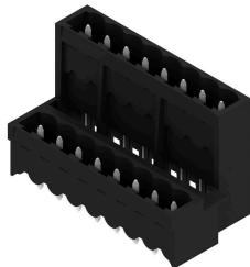
Hochtemperaturfeste, doppelstöckige, seitlich versetzte, geschlossene Stifteleiste optional mit Lötfansch. Lötstift 1,5 mm für Reflowlötanwendungen geeignet. Lötstift 3,2 mm für Reflow- und Wellenlötanwendungen geeignet. Die Stifteleisten bieten Platz für Beschriftungen und können kodiert werden.
