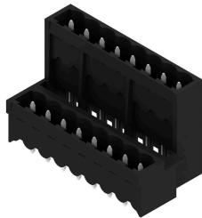
Hochtemperaturfeste, doppelstöckige, seitlich versetzte, geschlossene Stifteleiste optional mit Lötfansch. Lötstift 1,5 mm für Reflowlötanwendungen geeignet. Lötstift 3,2 mm für Reflow- und Wellenlötanwendungen geeignet. Die Stifteleisten bieten Platz für Beschriftungen und können kodiert werden.
