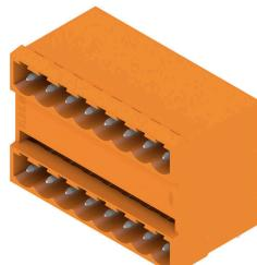
Doppelstöckige Stiftleiste mit parallelem Steckgesicht. Die Lötstiftlänge ist für Wellenlötanwendungen optimiert. Die Stiftleisten bieten Platz für Beschriftungen und können kodiert werden.
