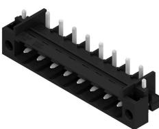
Hochtemperaturfeste, gerade, offene Stifteleiste. Verpackung in Box oder Tape. Im Tape und mit 1,5 mm Lötstift optimiert für die Automatenbestückung. Lötstift 3,2 mm für Reflow- und Wellenlötanwendungen geeignet. Die Stifteleisten sind beschriftbar und können kodiert werden. HC = High Current.
