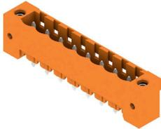
Stiftleisten aus glasfaserverstärktem Kunststoff mit gerader Abgangsrichtung optimiert für den Wellenlötprozess. Die Variante mit Flansch (F) lässt sich zur Verschraubung mit dem jeweiligen Gegenstück oder der Leiterplatte nutzen. Beim Einsatz der Lötflansch-Variante entfällt eine zusätzliche Verschraubung mit der Leiterplatte. Gleichzeitig werden die Lötstellen vor mechanischem Stress geschützt. Die Stiftleisten können manuell kodiert oder bereits vorkodiert bestellt werden. HC = High Current.
