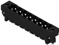
Hochtemperaturfeste Stiftleiste mit Verpackung in Box oder Tape. Im Tape mit 1,5 mm Lötstift optimiert für die Automatenbestückung. Lötstift 3,2 mm für Reflow- und Wellenlötanwendungen geeignet. Die Stiftleisten sind beschriftbar und können kodiert werden. HC = High Current.
