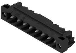
Hochtemperaturfeste Stiftleiste mit Verpackung in Box oder Tape. Im Tape mit 1,5 mm Lötstift optimiert für die Automatenbestückung. Lötstift 3,2 mm für Reflow- und Wellenlötanwendungen geeignet. Die Stiftleisten sind beschriftbar und können kodiert werden. HC = High Current.
