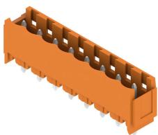
Stiftleisten aus glasfaserverstärktem Kunststoff mit gerader Abgangsrichtung optimiert für den Wellenlötprozess. Die Variante mit Flansch (F) lässt sich zur Verschraubung mit dem jeweiligen Gegenstück oder der Leiterplatte nutzen. Beim Einsatz der Lötplansch-Variante entfällt eine zusätzliche Verschraubung mit der Leiterplatte. Gleichzeitig werden die Lötstellen vor mechanischem Stress geschützt. Die Stiftleisten können manuell kodiert oder bereits vorkodiert bestellt werden.
