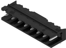
Hochtemperaturfeste, 90° abgewinkelte, offene Stiftleiste. Verpackung in Box oder Tape. Im Tape mit 1,5 mm Lötstift optimiert für die Automatenbestückung. Lötstift 3,2 mm für Reflow- und Wellenlötanwendungen geeignet. Die Stiftleisten sind beschriftbar und können kodiert werden. HC = High Current.
