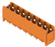
Stiftleisten aus glasfaserverstärktem Kunststoff mit gerader Abgangsrichtung optimiert für den Wellenlötprozess. Die Variante mit Flansch (F) lässt sich zur Verschraubung mit dem jeweiligen Gegenstück oder der Leiterplatte nutzen. Beim Einsatz der Lötfansch-Variante entfällt eine zusätzliche Verschraubung mit der Leiterplatte. Gleichzeitig werden die Lötstellen vor mechanischem Stress geschützt. Die Stiftleisten können manuell kodiert oder bereits vorkodiert bestellt werden. HC = High Current.
