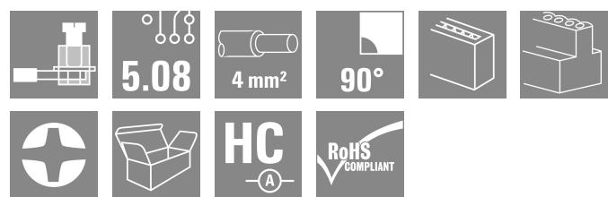
Buchsenstecker mit Schraubanschluss in Zugbügeltechnik für Leiteranschluss mit rechtwinkliger (90° bzw. 270°) Abgangsrichtung. Die Buchsenstecker bieten Platz für Beschriftungen und können kodiert werden. Befestigung mittels Flansch oder Löseriegel möglich. Sie bieten zusätzlich integrierte Plus/Minus-Schraube, Leiterunterstellschutz und werden mit geöffnetem Zugbügel geliefert. HC = High Current.
