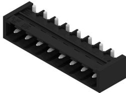
Hochtemperaturfeste, gerade, offene Stifteiste. Verpackung in Box oder Tape. Im Tape und mit 1,5 mm Lötstift optimiert für die Automatenbestückung. Lötstift 3,2 mm für Reflow- und Wellenlötanwendungen geeignet. Die Stifteisten sind beschriftbar und können kodiert werden. HC = High Current.
