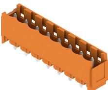
Stiftleisten aus glasfaserverstärktem Kunststoff mit gerader Abgangsrichtung optimiert für den Wellenlötprozess. Die Variante mit Flansch (F) lässt sich zur Verschraubung mit dem jeweiligen Gegenstück oder der Leiterplatte nutzen. Beim Einsatz der Lötfansch-Variante entfällt eine zusätzliche Verschraubung mit der Leiterplatte. Gleichzeitig werden die Lötstellen vor mechanischem Stress geschützt. Die Stiftleisten können manuell kodiert oder bereits vorkodiert bestellt werden.
