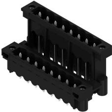
Hochtemperaturfeste, doppelstöckige, seitlich versetzte, Stiftleiste mit Flansch bzw. Lötfansch. Lötstift 1,5 mm für Reflowlötanwendungen geeignet. Lötstift 3,2 mm für Reflow- und Wellenlötanwendungen geeignet. Die Stiftleisten bieten Platz für Beschriftungen und können kodiert werden.
