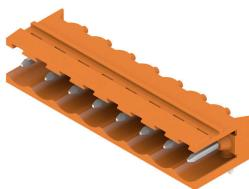
Stiftleisten aus glasfaserverstärktem Kunststoff mit 90° Abgangsrichtung optimiert für den Wellenlötprozess. Die Variante mit Flansch (F) lässt sich zur Verschraubung mit dem jeweiligen Gegenstück oder der Leiterplatte nutzen. Beim Einsatz der Lötfansch-Variante (LF) entfällt eine zusätzliche Verschraubung mit der Leiterplatte. Gleichzeitig werden hierbei die Lötstellen vor mechanischem Stress geschützt. Die Stiftleisten können manuell kodiert oder bereits vorkodiert bestellt werden.
