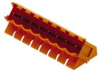
Stifteleisten mit 135° Abgangsrichtung. Die Lötstiftlänge ist für Wellenlötanwendungen optimiert. Die Stifteleisten bieten Platz für Beschriftungen und können kodiert werden.
