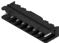
Hochtemperaturfeste, 90° abgewinkelte, offene Stifteleiste. Verpackung in Box oder Tape. Im Tape mit 1,5 mm Lötstift optimiert für die Automatenbestückung. Lötstift 3,2 mm für Reflow- und Wellenlötanwendungen geeignet. Die Stifteleisten sind beschriftbar und können kodiert werden. HC = High Current.
