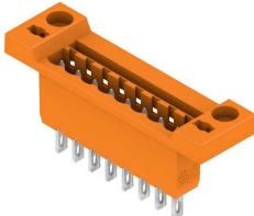
Durchführungsstifteleiste zur Frontplattenmontage mit optionaler Verriegelungsfunktion. Der interne Anschluss erfolgt als Flachsteck- oder Lötanschluss. Die Stifteleisten sind beschriftbar und können kodiert werden.
