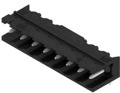
Hochtemperaturfeste, 90° abgewinkelte, offene Stifteleiste. Verpackung in Box oder Tape. Im Tape mit 1,5 mm Lötstift optimiert für die Automatenbestückung. Lötstift 3,2 mm für Reflow- und Wellenlötanwendungen geeignet. Die Stifteleisten sind beschriftbar und können kodiert werden. HC = High Current.
