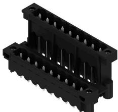
Hochtemperaturfeste, doppelstöckige, seitlich versetzte, Stifteleiste mit Flansch bzw. Lötfansch. Lötstift 1,5 mm für Reflowlötanwendungen geeignet. Lötstift 3,2 mm für Reflow- und Wellenlötanwendungen geeignet. Die Stifteleisten bieten Platz für Beschriftungen und können kodiert werden.
