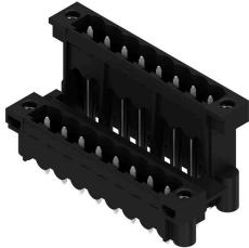
Hochtemperaturfeste, doppelstöckige, seitlich versetzte, Stifteleiste mit Flansch bzw. Lötfansch. Lötstift 1,5 mm für Reflowlötanwendungen geeignet. Lötstift 3,2 mm für Reflow- und Wellenlötanwendungen geeignet. Die Stifteleisten bieten Platz für Beschriftungen und können kodiert werden.
