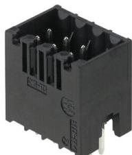
Hochtemperaturfeste, zweireihige Stiftleiste für alle gängigen Lötverfahren. Optimierte für die Automatenbestückung. Verpackung in Box oder Tape. Stiftlänge 3,2 mm für Reflow- und Wellenlötanwendungen geeignet. Die Stiftleisten bieten Platz für Beschriftungen und können kodiert werden.
