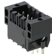
Hochtemperaturfeste, zweireihige Stifteleiste für alle gängigen Lötverfahren. Optimierte für die Automatenbestückung. Verpackung in Box oder Tape. Stiftlänge 3,2 mm für Reflow- und Wellenlötanwendungen geeignet. Die Stifteleisten bieten Platz für Beschriftungen und können kodiert werden.
