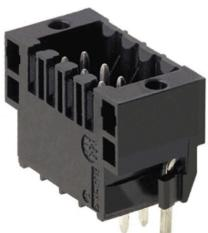
Hochtemperaturfeste, zweireihige Stiftleiste für alle gängigen Lötverfahren. Optimiert für die Automatenbestückung. Verpackung in Box oder Tape. Stiftlänge 3,2 mm für Reflow- und Wellenlötanwendungen geeignet. Die Stiftleisten bieten Platz für Beschriftungen und können kodiert werden.
