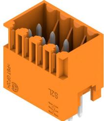
Gerade, zweireihige Stifteleiste in den Ausführungen seitlich geschlossen oder mit Flansch (seitlich offene Stifteleisten auf Anfrage). Die Stifteleisten mit der Stiftlänge 3,5 mm sind für das Wellenlöten ausgelegt und in einer Box-Verpackung. Ein Verschrauben mit der Leiterplatte ist möglich. Die Stifteleisten bieten Platz für Beschriftung und können kodiert werden.
