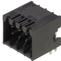
Hochtemperaturfeste, zweireihige Stifteleiste für alle gängigen Lötverfahren. Optimierte für die Automatenbestückung. Verpackung in Box oder Tape. Stiftlänge 3,2 mm für Reflow- und Wellenlötanwendungen geeignet. Die Stifteleisten bieten Platz für Beschriftungen und können kodiert werden.
