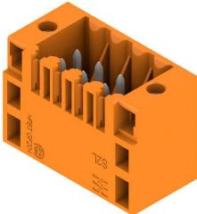
Gerade, zweireihige Stiftleiste in den Ausführungen seitlich geschlossen oder mit Flansch (seitlich offene Stiftleisten auf Anfrage). Die Stiftleisten mit der Stiftlänge 3,5 mm sind für das Wellenlöten ausgelegt und in einer Box-Verpackung. Ein Verschrauben mit der Leiterplatte ist möglich. Die Stiftleisten bieten Platz für Beschriftung und können kodiert werden.
