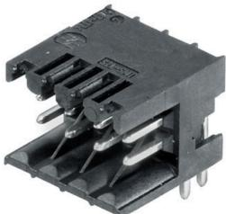
Hochtemperaturfeste, zweireihige Stifteleiste für alle gängigen Lötverfahren. Optimierte für die Automatenbestückung. Verpackung in Box oder Tape. Stiftlänge 3,2 mm für Reflow- und Wellenlötanwendungen geeignet. Die Stifteleisten bieten Platz für Beschriftungen und können kodiert werden.
