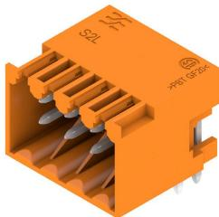
Abgewinkelte, zweireihige Stifteleiste in den Ausführungen seitlich geschlossen oder mit Flansch (seitlich offene Stifteleisten auf Anfrage). Die Stifteleisten mit der Stiftlänge 3,5 mm sind für das Wellenlöten ausgelegt und in einer Box-Verpackung. Ein Verschrauben mit der Leiterplatte ist möglich. Die Stifteleisten bieten Platz für Beschriftungen und können kodiert werden.
