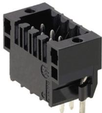
Hochtemperaturfeste, zweireihige Stifteleiste für alle gängigen Lötverfahren. Optimierte für die Automatenbestückung. Verpackung in Box oder Tape. Stiftlänge 3,2 mm für Reflow- und Wellenlötanwendungen geeignet. Die Stifteleisten bieten Platz für Beschriftungen und können kodiert werden.
