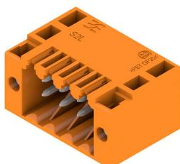
Abgewinkelte, zweireihige Stifteleiste in den Ausführungen seitlich geschlossen oder mit Flansch (seitlich offene Stifteleisten auf Anfrage). Die Stifteleisten mit der Stiftlänge 3,5 mm sind für das Wellenlöten ausgelegt und in einer Box-Verpackung. Ein Verschrauben mit der Leiterplatte ist möglich. Die Stifteleisten bieten Platz für Beschriftungen und können kodiert werden.
