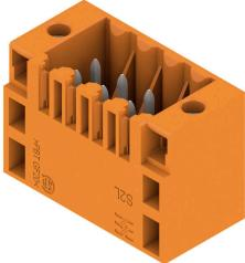
Gerade, zweireihige Stifteleiste in den Ausführungen seitlich geschlossen oder mit Flansch (seitlich offene Stifteleisten auf Anfrage). Die Stifteleisten mit der Stiftlänge 3,5 mm sind für das Wellenlöten ausgelegt und in einer Box-Verpackung. Ein Verschrauben mit der Leiterplatte ist möglich. Die Stifteleisten bieten Platz für Beschriftung und können kodiert werden.
