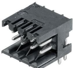
Hochtemperaturfeste, zweireihige Stifteleiste für alle gängigen Lötverfahren. Optimierte für die Automatenbestückung. Verpackung in Box oder Tape. Stiftlänge 3,2 mm für Reflow- und Wellenlötanwendungen geeignet. Die Stifteleisten bieten Platz für Beschriftungen und können kodiert werden. (Tapeverpackung auf Anfrage)
