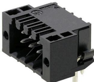
Hochtemperaturfeste, zweireihige Stifteleiste für alle gängigen Lötverfahren. Optimierte für die Automatenbestückung. Verpackung in Box oder Tape. Stiftlänge 3,2 mm für Reflow- und Wellenlötanwendungen geeignet. Die Stifteleisten bieten Platz für Beschriftungen und können kodiert werden.
