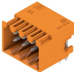
Abgewinkelte, zweireihige Stiftleiste in den Ausführungen seitlich geschlossen oder mit Flansch (seitlich offene Stiftleisten auf Anfrage). Die Stiftleisten mit der Stiftlänge 3,5 mm sind für das Wellenlöten ausgelegt und in einer Box-Verpackung. Ein Verschrauben mit der Leiterplatte ist möglich. Die Stiftleisten bieten Platz für Beschriftungen und können kodiert werden.
