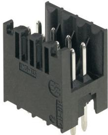
Hochtemperaturfeste, zweireihige Stifteleiste für alle gängigen Lötverfahren. Optimiert für die Automatenbestückung. Verpackung in Box oder Tape. Stiftlänge 3,2 mm für Reflow- und Wellenlötanwendungen geeignet. Die Stifteleisten bieten Platz für Beschriftungen und können kodiert werden.
