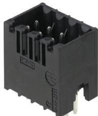
Hochtemperaturfeste, zweireihige Stifteleiste für alle gängigen Lötverfahren. Optimierte für die Automatenbestückung. Verpackung in Box oder Tape. Stiftlänge 3,2 mm für Reflow- und Wellenlötanwendungen geeignet. Die Stifteleisten bieten Platz für Beschriftungen und können kodiert werden.
