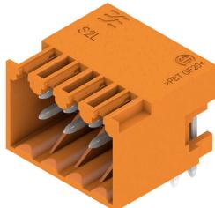
Abgewinkelte, zweireihige Stifteleiste in den Ausführungen seitlich geschlossen oder mit Flansch (seitlich offene Stifteleisten auf Anfrage). Die Stifteleisten mit der Stiftlänge 3,5 mm sind für das Wellenlöten ausgelegt und in einer Box-Verpackung. Ein Verschrauben mit der Leiterplatte ist möglich. Die Stifteleisten bieten Platz für Beschriftungen und können kodiert werden.
