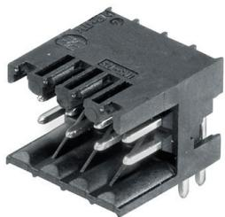
Hochtemperaturfeste, zweireihige Stifteleiste für alle gängigen Lötverfahren. Optimiert für die Automatenbestückung. Verpackung in Box oder Tape. Stiftlänge 3,2 mm für Reflow- und Wellenlötanwendungen geeignet. Die Stifteleisten bieten Platz für Beschriftungen und können kodiert werden.
