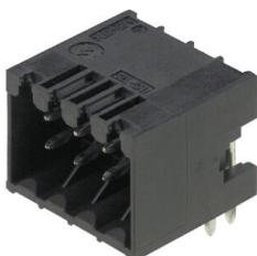
Hochtemperaturfeste, zweireihige Stifteleiste für alle gängigen Lötverfahren. Optimiert für die Automatenbestückung. Verpackung in Box oder Tape. Stiftlänge 3,2 mm für Reflow- und Wellenlötanwendungen geeignet. Die Stifteleisten bieten Platz für Beschriftungen und können kodiert werden.
