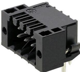
Hochtemperaturfeste, zweireihige Stifteleiste für alle gängigen Lötverfahren. Optimierte für die Automatenbestückung. Verpackung in Box oder Tape. Stiftlänge 3,2 mm für Reflow- und Wellenlötanwendungen geeignet. Die Stifteleisten bieten Platz für Beschriftungen und können kodiert werden.
