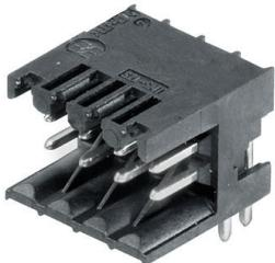
Hochtemperaturfeste, zweireihige Stifteleiste für alle gängigen Lötverfahren. Optimiert für die Automatenbestückung. Verpackung in Box oder Tape. Stiftlänge 3,2 mm für Reflow- und Wellenlötanwendungen geeignet. Die Stifteleisten bieten Platz für Beschriftungen und können kodiert werden. (Tapeverpackung auf Anfrage)
