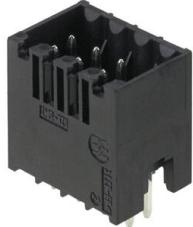
Hochtemperaturfeste, zweireihige Stifteleiste für alle gängigen Lötverfahren. Optimiert für die Automatenbestückung. Verpackung in Box oder Tape. Stiftlänge 3,2 mm für Reflow- und Wellenlötanwendungen geeignet. Die Stifteleisten bieten Platz für Beschriftungen und können kodiert werden.
