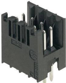
Hochtemperaturfeste, zweireihige Stifteleiste für alle gängigen Lötverfahren. Optimierte für die Automatenbestückung. Verpackung in Box oder Tape. Stiftlänge 3,2 mm für Reflow- und Wellenlötanwendungen geeignet. Die Stifteleisten bieten Platz für Beschriftungen und können kodiert werden.
