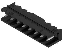
Hochtemperaturfeste, 90° abgewinkelte, offene Stiftleiste. Verpackung in Box oder Tape. Im Tape mit 1,5 mm Lötstift optimiert für die Automatenbestückung. Lötstift 3,2 mm für Reflow- und Wellenlötanwendungen geeignet. Die Stiftleisten sind beschriftbar und können kodiert werden. HC = High Current.
