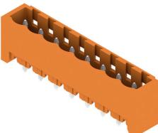
Stifteleisten aus glasfaserverstärktem Kunststoff mit gerader Abgangsrichtung optimiert für den Wellenlötprozess. Die Variante mit Flansch (F) lässt sich zur Verschraubung mit dem jeweiligen Gegenstück oder der Leiterplatte nutzen. Beim Einsatz der Lötfansch-Variante entfällt eine zusätzliche Verschraubung mit der Leiterplatte. Gleichzeitig werden die Lötstellen vor mechanischem Stress geschützt. Die Stifteleisten können manuell kodiert oder bereits vorkodiert bestellt werden. HC = High Current.
