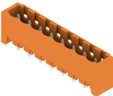
Stiftleisten aus glasfaserverstärktem Kunststoff mit gerader Abgangsrichtung optimiert für den Wellenlötprozess. Die Variante mit Flansch (F) lässt sich zur Verschraubung mit dem jeweiligen Gegenstück oder der Leiterplatte nutzen. Beim Einsatz der Lötflansch-Variante entfällt eine zusätzliche Verschraubung mit der Leiterplatte. Gleichzeitig werden die Lötstellen vor mechanischem Stress geschützt. Die Stiftleisten können manuell kodiert oder bereits vorkodiert bestellt werden.
