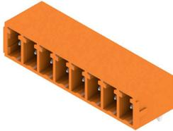
Die Stiftleiste SC bietet eine Steckrichtung parallel zur Leiterplatte (liegend) und ist in geschlossener (G) Variante und mit Schraubflansch (F) verfügbar. Die Weidmüller Steckverbinder im Raster 3,81 mm (0.15 inch) sind layout-kompatibel zu gängigen Steckverbindern und bieten Platz für Bedruckung und Kodierung sowie eine Aufnahme für Flutlichtanzeige.
