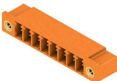
Die Stiftleiste SC bietet eine Steckrichtung parallel zur Leiterplatte (liegend) und ist in geschlossener (G) Variante und mit Schraubflansch (F) verfügbar. Die Weidmüller Steckverbinder im Raster 3,81 mm (0.15 inch) sind layout-kompatibel zu gängigen Steckverbindern und bieten Platz für Bedruckung und Kodierung sowie eine Aufnahme für Flutlichtanzeige.
