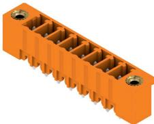
Die Stiftleiste SC bietet eine Steckrichtung senkrecht zur Leiterplatte (stehend) und ist in geschlossener (G) Variante und mit Schraubflansch (F) verfügbar. Die Weidmüller Steckverbinder im Raster 3,81 mm (0.15 inch) sind layout-kompatibel zu gängigen Steckverbindern und bieten Platz für Bedruckung und Kodierung.
