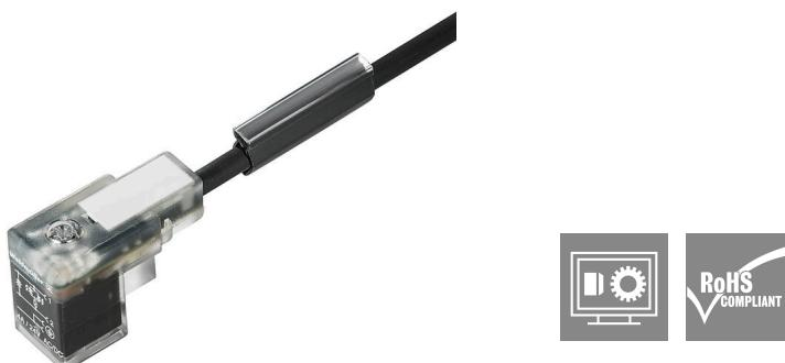
Weidmüller bietet Ventilstecker als Verbindungsleitung mit M8/M12 Steckern und mit freiem Leitungsende an. Der Betriebszustand des Ventilsteckers wird durch ein LED angezeigt. Die Ventilstecker besitzen eine Schutzbeschaltung. Das Weidmüllerlieferprogramm umfasst Ventilstecker der Bauformen A, B, C nach DIN und Industriestandard. Die Schutzart IP 67 wird im verschraubten Zustand erfüllt. Die Abgangsrichtung ist gleichfalls entscheidend, daher bietet Weidmüller unterschiedliche Versionen an.
