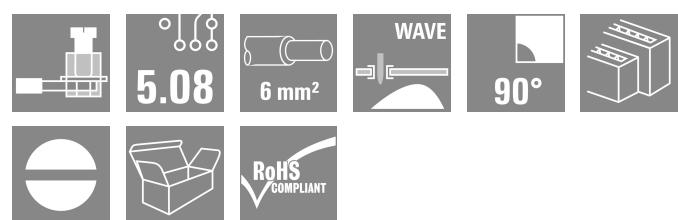
Niedrige einreihige und mehrreihige Leiterplattenklemmen mit bewährtem Zugbügelanschluss im Raster 5,00 mm und 5,08 mm mit Leiterabgangsrichtung in 90°-Ausführung. Für Leiterquerschnitte bis 6,0 mm<sup>2</sup> geeignet.
