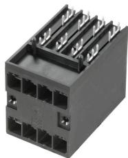
Zweireihige Hochstrom High Performance Stifteleisten, mit oder ohne Flansch zur schnellen, werkzeuglosen Verriegelung. Optimierte für „Book- Size Module“ ab einer Baubreite von 50mm. Mit integrierte Befestigungsmöglichkeit an der Gehäusewand. Höchste Bedienungs- und Betriebssicherheit durch 100% fehlstecksicheres Steckgesicht, einzigartige Kodiervielfalt und optional zusätzlicher Schraubbefestigung im Flansch.
