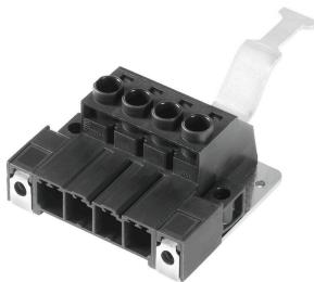
High Performance Stifteleiste mit dem bewährten, 100% wartungsfreien Weidmüller-Stahlzugbügel. Polverlustfrei anreihbar oder mit patentiertem Multifunktionsflansch zur sicheren, schnellen und werkzeuglosen Verriegelung. Höchste Bedienungs- und Betriebssicherheit durch 100% fehlstecksicheres Steckgesicht, einzigartige Kodiervielfalt, Fehlverdrahtungsschutz. Beschriftbar.
