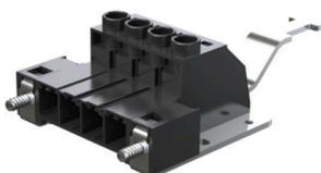
High Performance Stiftleiste mit dem bewährten, 100% wartungsfreien Weidmüller-Stahlzugbügel. Polverlustfrei anreihbar oder mit patentiertem Multifunktionsflansch zur sicheren, schnellen und werkzeuglosen Verriegelung. Höchste Bedienungs- und Betriebssicherheit durch 100% fehlstecksicheres Steckgesicht, einzigartige Kodiervielfalt, Fehlverdrahtungsschutz. Beschriftbar.
