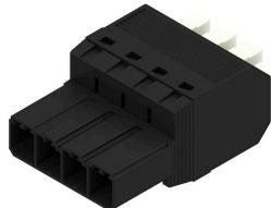
180°-invertierte Stifteleiste mit PUSH-IN Anschlusstechnologie mit aufstellbarem Betätiger (Pusher) für die Feldverdrahtung in 6 mm<sup>2</sup> im Raster 7.62. Ideal auch als fingersichere Lösung bei Rückspannung. Erfüllt die Anforderungen gemäß UL1059 600 V Class C und IEC 61800-5-1. Varianten: ohne Flansch, Außenflansch, Mittelflansch mit Rastbefestigung und optional zusätzliche Schraubbefestigung.
