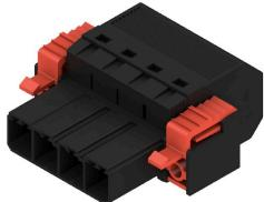
Invertierte Stiftleiste mit PUSH IN Anschlusstechnologie für die Feldverdrahtung mit invertierten Außenflanschen in 6 mm<sup>2</sup> im Raster 7.62. Ideal auch als fingersichere Lösung bei Rückspannung. Erfüllt die Anforderungen gemäß UL1059 600 V Class C und IEC 61800-5-1. Optional auch verschraubar und ohne Flansch lieferbar.
