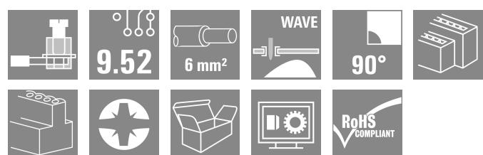
2-reihige Leiterplattenklemme mit bewährtem Zugbügelanschluss im Raster 9,52 mm. Leiterabgangsrichtung in 90°-Ausführung. 1000 Volt und 6 mm<sup>2</sup> Leiterquerschnitt für 32 A.
