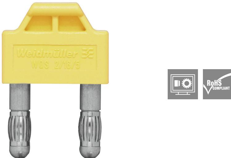
Die Verteilung oder Vervielfältigung eines Potentials auf benachbarte Reihenklemmen wird über eine Querverbindung realisiert. Zusätzlicher Verdrahtungsaufwand lässt sich so einfach vermeiden. Auch bei ausgebrochenen Polen ist weiterhin eine Kontaktsicherheit in den Reihenklemmen gewährleistet. Unser Portfolio bietet steck- und schraubbare Querverbindungssysteme für Reihenklemmen an.
