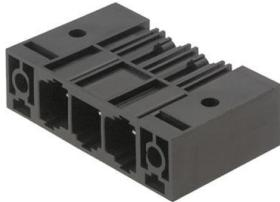
Einreihige High Performance Stiftleiste, polverlustfrei anreichbar oder mit patentiertem Flansch zur schnellen, werkzeuglosen Verriegelung. Höchste Bedienungs- und Betriebssicherheit durch 100% fehlstecksicheres Steckgesicht, einzigartige Kodiervielfalt und Zusatzbefestigung im Flansch. Stiftlänge mit 3,5 mm optimiert für den Wellenlötprozess, Steckrichtung 270° zu den Lötstiften.
