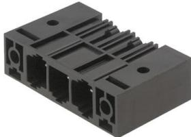
Einreihige High Performance Stifteleiste, polverlustfrei anreichbar oder mit patentiertem Flansch zur schnellen, werkzeuglosen Verriegelung. Höchste Bedienungs- und Betriebssicherheit durch 100% fehlstecksicheres Steckgesicht, einzigartige Kodiervielfalt und Zusatzbefestigung im Flansch. Stiftlänge mit 3,5 mm optimiert für den Wellenlötprozess, Steckrichtung 270° zu den Lötstiften.
