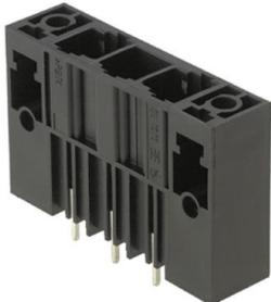
Einreihige Hochstrom-Stifteleiste, polverlustfrei anreichbar oder mit patentiertem Flansch zur schnellen, werkzeuglosen Verriegelung. Höchste Bedienungs- und Betriebssicherheit durch 100% fehlstecksicheres Steckgesicht, einzigartige Kodiervielfalt, Zusatzbefestigung und integrierbare Positionierhilfe. Stiftlänge mit 3,5 mm optimiert für den Wellenlötprozess, Steckrichtung 180° zu den Lötstiften.
