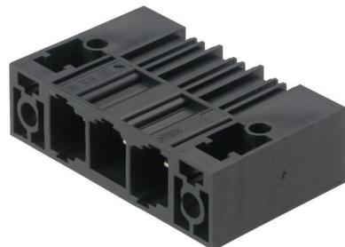
Einreihige Hochstrom-Stifteleiste, polverlustfrei anreichbar oder mit patentiertem Flansch zur schnellen, werkzeuglosen Verriegelung. Höchste Bedienungs- und Betriebssicherheit durch 100% fehlstecksicheres Steckgesicht, einzigartige Kodiervielfalt und Zusatzbefestigung im Flansch. Stiftlänge mit 3,5 mm optimiert für den Wellenlötprozess Steckrichtung 90° zu den Lötstiften.
