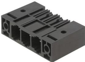
Einreihige High Performance Stifteleiste, polverlustfrei anreichbar oder mit patentiertem Flansch zur schnellen, werkzeuglosen Verriegelung. Höchste Bedienungs- und Betriebssicherheit durch 100% fehlstecksicheres Steckgesicht, einzigartige Kodiervielfalt und Zusatzbefestigung im Flansch. Stiftlänge mit 3,5 mm optimiert für den Wellenlötprozess, Steckrichtung 270° zu den Lötstiften.
