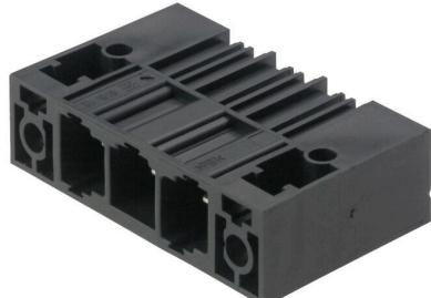
Einreihige Hochstrom-Stiftleiste, polverlustfrei anreihbar oder mit patentiertem Flansch zur schnellen, werkzeuglosen Verriegelung. Höchste Bedienungs- und Betriebssicherheit durch 100% fehlstecksicheres Steckgesicht, einzigartige Kodiervielfalt und Zusatzbefestigung im Flansch. Stiftlänge mit 3,5 mm optimiert für den Wellenlötprozess Steckrichtung 90° zu den Lötstiften.
