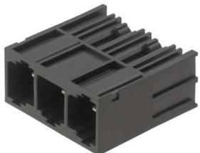
Einreihige High Performance Stifteleiste, polverlustfrei anreichbar oder mit patentiertem Flansch zur schnellen, werkzeuglosen Verriegelung. Höchste Bedienungs- und Betriebssicherheit durch 100% fehlstecksicheres Steckgesicht, einzigartige Kodiervielfalt und Zusatzbefestigung im Flansch. Stiftlänge mit 3,5 mm optimiert für den Wellenlötprozess, Steckrichtung 270° zu den Lötstiften.
