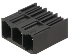
Einreihige Hochstrom-Stifteleiste, polverlustfrei anreichbar oder mit patentiertem Flansch zur schnellen, werkzeuglosen Verriegelung. Höchste Bedienungs- und Betriebssicherheit durch 100% fehlstecksicheres Steckgesicht, einzigartige Kodiervielfalt und Zusatzbefestigung im Flansch. Stiftlänge mit 3,5 mm optimiert für den Wellenlötprozess Steckrichtung 90° zu den Lötstiften.
