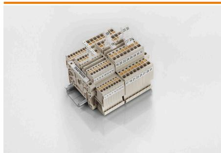
SnapMark - Dieser Schildträger ist speziell für die Doppelstockklemme IDK 1.5N der I-Reihe entwickelt worden. Durch den flexiblen Schwenkmechanismus lassen sich Querverbindungen ohne Aufwand montieren oder entnehmen. Er kann mit vier DEK 5 Bezeichnungsschildern oder zwei WS 10/5 Middle Verbindelementen bestückt werden.
